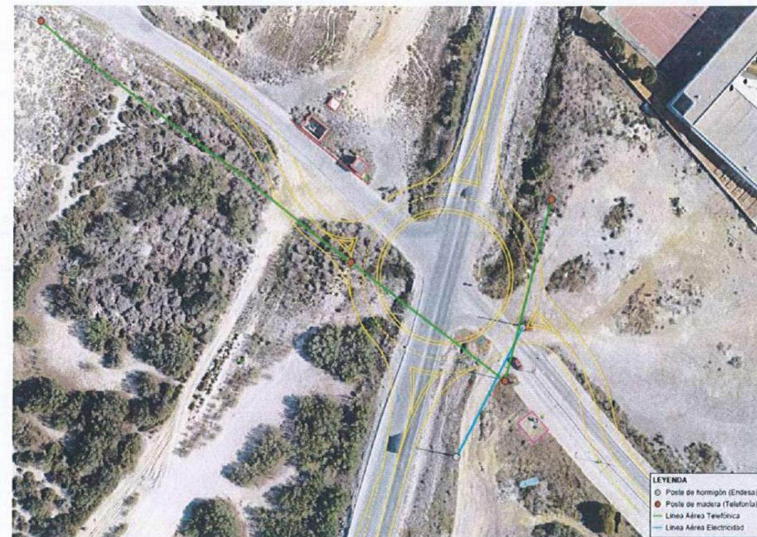
En lo que respecta a la red de telefonía se realizará un soterramiento y desvío de la misma hasta conectar con un poste existente en la zona. Se retirará el poste de madera que existe en mitad del trazado del Ramal Oeste, manteniéndose los demás.
